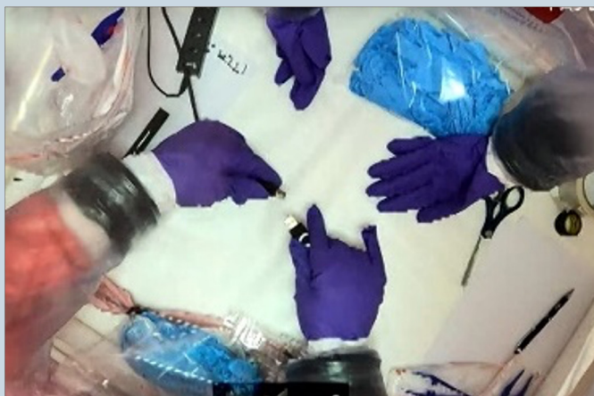
Рисунок 3. Восстановление удаленных файлов с USB-накопителя Примечание: USB-накопитель помещается в перчаточный мешок для цифрового анализа, после чего подключается к кабелю. Устройство для цифрового анализа остается за пределами перчаточного мешка.
