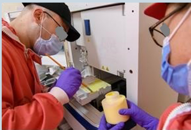
Рис. 8. Защита генетического анализатора с помощью дезактивирующего геля
