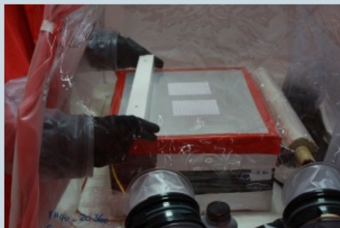
Рис. 6. Применение электростатического тонер-порошка для выявления вдавленных следов письма на бумаге в вакуумной камере
