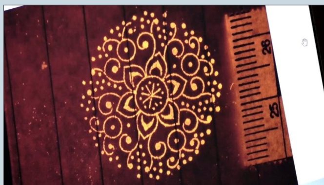
Рис. 10. «Отпечаток пальца», сфотографированный в монохроматическом свете после выявления методом окуривания цианоакрилатом
