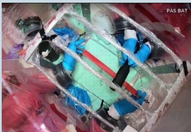
Рис. 5. Пористая клейкая лента подвергается нагреву после опрыскивания индандионом
