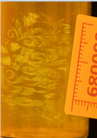
Рис. 4. Участки папиллярных линий, выделенные с помощью химического окрашивания и цианакрилатного окуривания, на «Объекте 5/ES-1».
