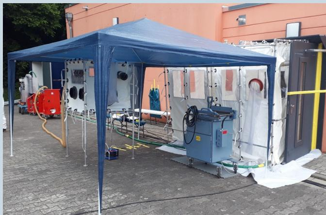
**Рис. 1.** Шлюзовая камера для персонала и вещдоков на входе / выходе из зараженного места преступления. На фотографии изображены устройство для термосклеивания упаковок и мобильный перчаточный бокс (во время учения ZUB)
