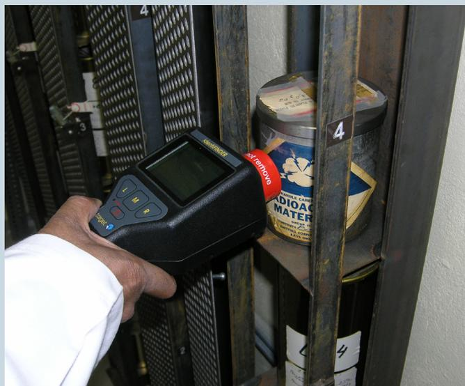
**Рис. 3.** Проведение измерений на объекте в Норвегии с помощью прибора IdentifINDER
