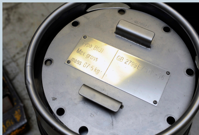
Рис. 3. Упаковка SAFKEG – многоразовая упаковка Типа В, разработанная в соответствии с Правилами МАГАТЭ по безопасной перевозке радиоактивных материалов. Фотография: Дин Кальма/ МАГАТЭ
