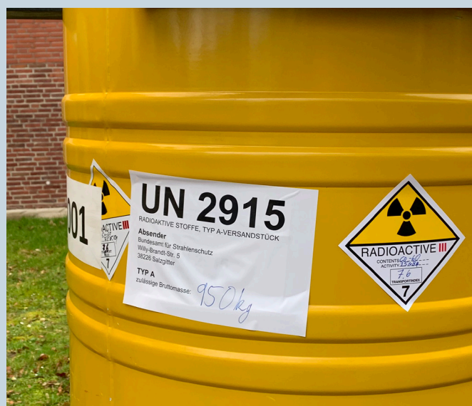
Рис. 1. Упаковка типа А, используемая для транспортировки источника кобальта-60 с места хранения в Radiochemistry Munich для дальнейшего исследования. Федеральное управление Германии по радиационной защите организовало перевозку в 2020 году.
