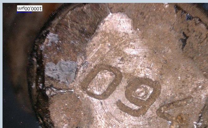
Рис. 7. Источник Co-60, обнаруженный в Гамбурге: номер в торцевой части. Фотография: BFS.
